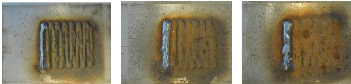
Figure 3. Welded at: a)17V b)19V c)21V
