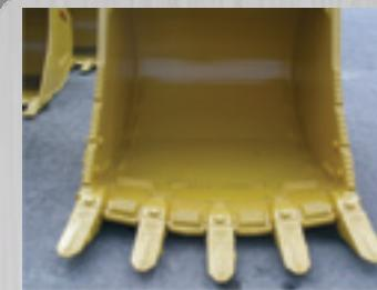
Korpa teškog utovarivača zaštićena je s DOMITE tvrdim metalima različitih geometrijskih oblika. Na slici su jasno vidljive ploče čokoladnog oblika, klizne ploče, profilirane zaštite i zaštite u obliku diskova.
