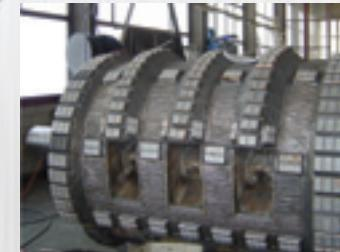
Internacionalni proizvođač opre-me za rudarstvo, tunelogradnju i otvorene kopove DBT iz Njemačke na svoje drobilice izložene najtvrdim abrazivnim medijima ugrađuje DOMITE ploče čokoladnog oblika raznih veličina. Prostor između tvrdo se navaruje s DURUM materijalima čime se osigurava dug i pouzdan rad.
