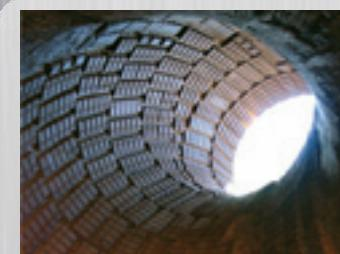
Jedna od najzahtjevnijih i najsurovijih industrija na svijetu – jaružanje ili dredging sustavno desetljećima koristi DOMITE zaštite od bijelog, lako zavarljivog ljeva tvrdoće 700HB. Na taj način, korozivni i abrazivni mediji s velikom količinom kamenja mogu biti zaustavljeni od uništavanja cjevovoda u kratkom periodu. DOMITE se uspješno primjenjuje i na ostale dijelove poput pumpi, usisnih grana.
