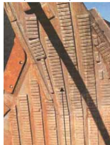
CB 130 Ploče čokoladnog oblika nakon 9000 radnih sati
