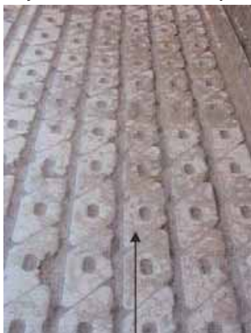
DLP 1935 Trapezne zaštitne ploče nakon 8000 radnih sati
